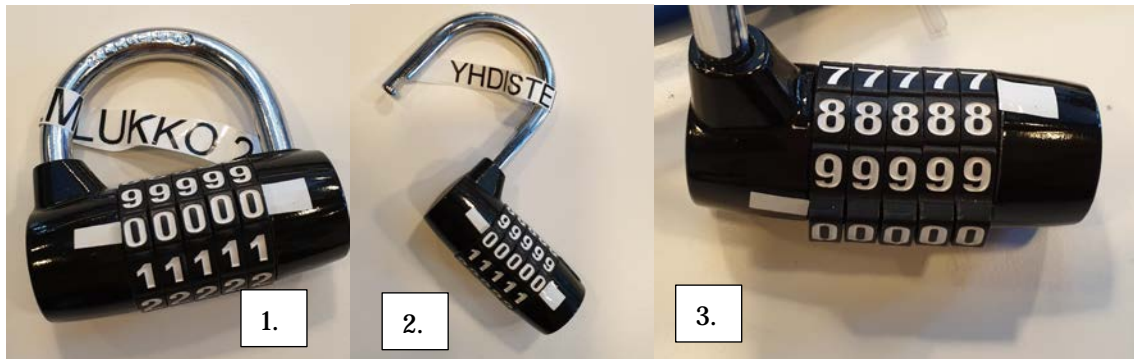
Kuva 1. Lukko kiinni, kuva 2. lukko auki, kuva 3. lukon pää käännettynä sarjoitukseen
